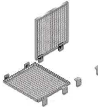
Mesh type grid to be fixed to the wall chamber Grille à mailles à fixer sur la paroi de chambre
